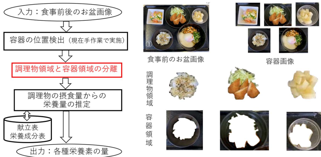
お盆画像からの摂食栄養量の自動計測システムのフローチャート
