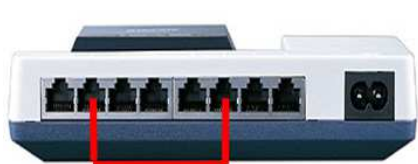
1本のケーブルがHUBに接続されている 絶対に行わないでください
