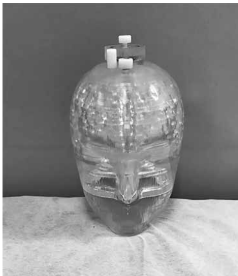
Fig. 1 国立循環器病研究センター研究所開発の 3D-Brain ファントム
